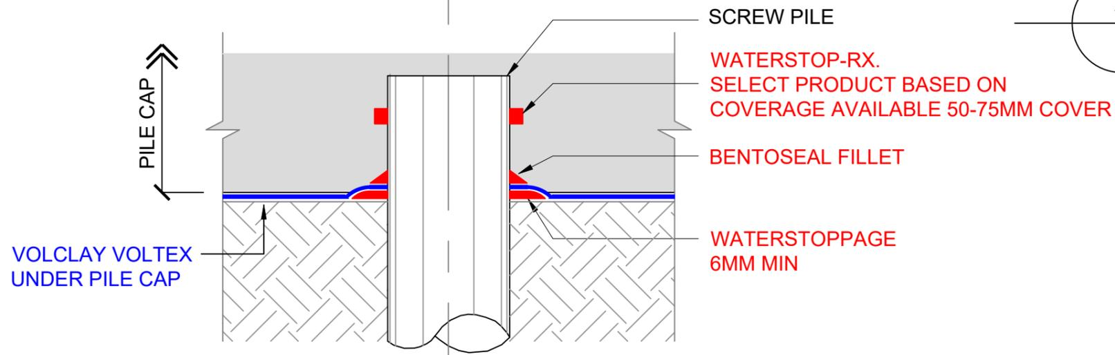
**3** PENETRATION - SCREW PILE / PILE CAP
