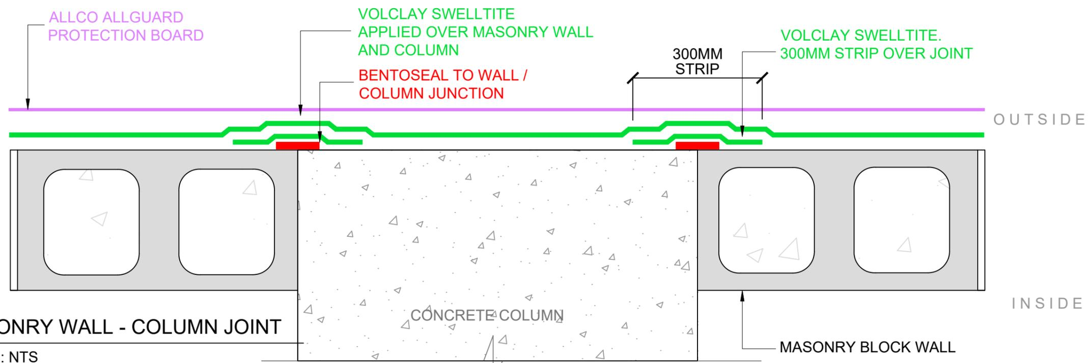
**2** MASONRY WALL - COLUMN JOINT
