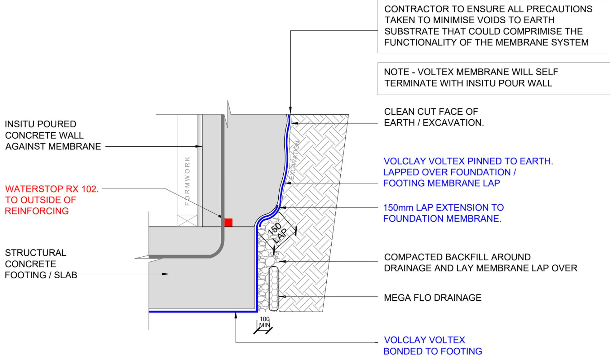
1 FLUSH FOOTING / WALL - VOLTEX PINNED TO EARTH - INSITU WALL
