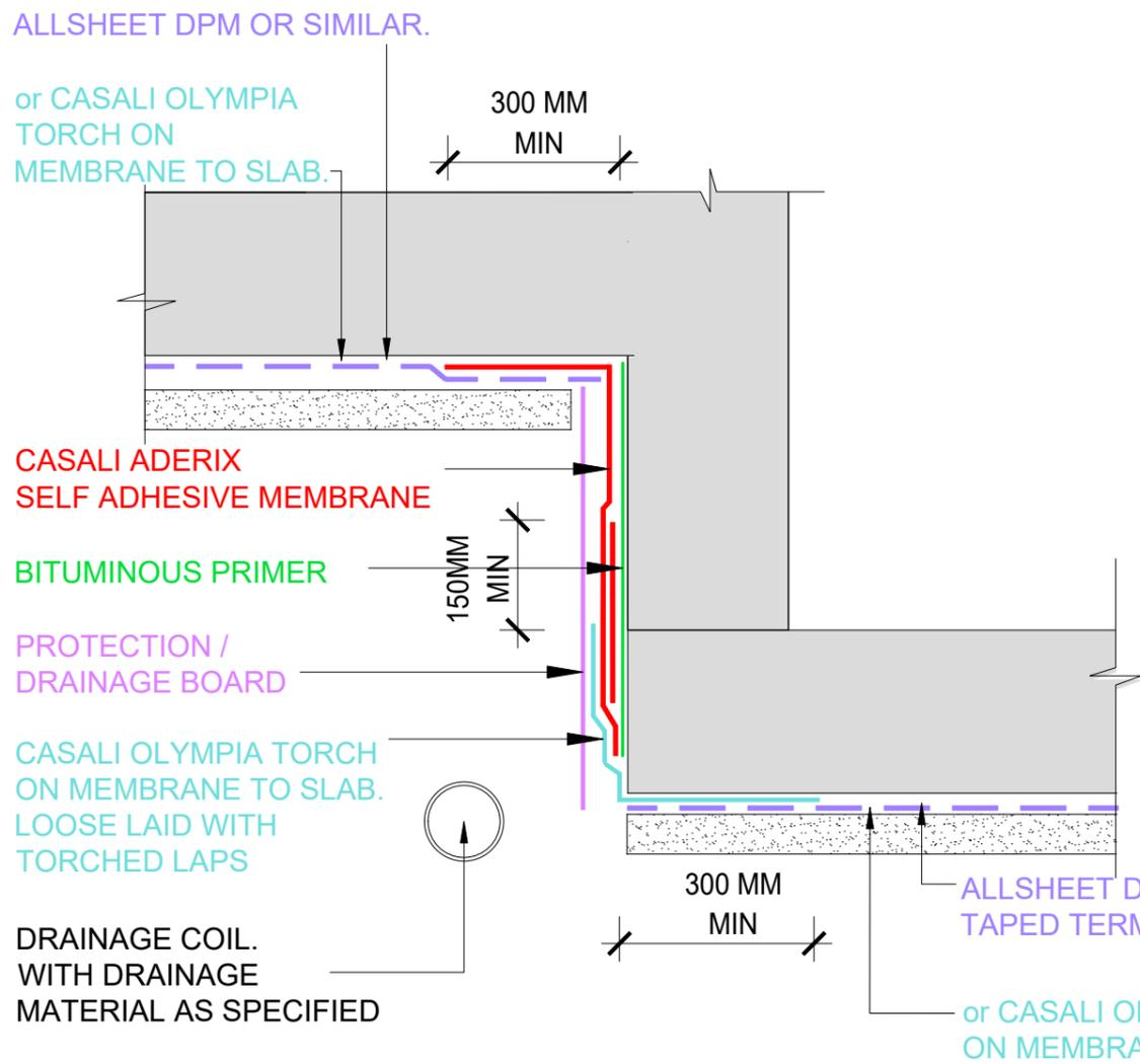
**1 RETAINING WALL / FLUSH FOOTING JUNCTION - MULTILEVEL**
