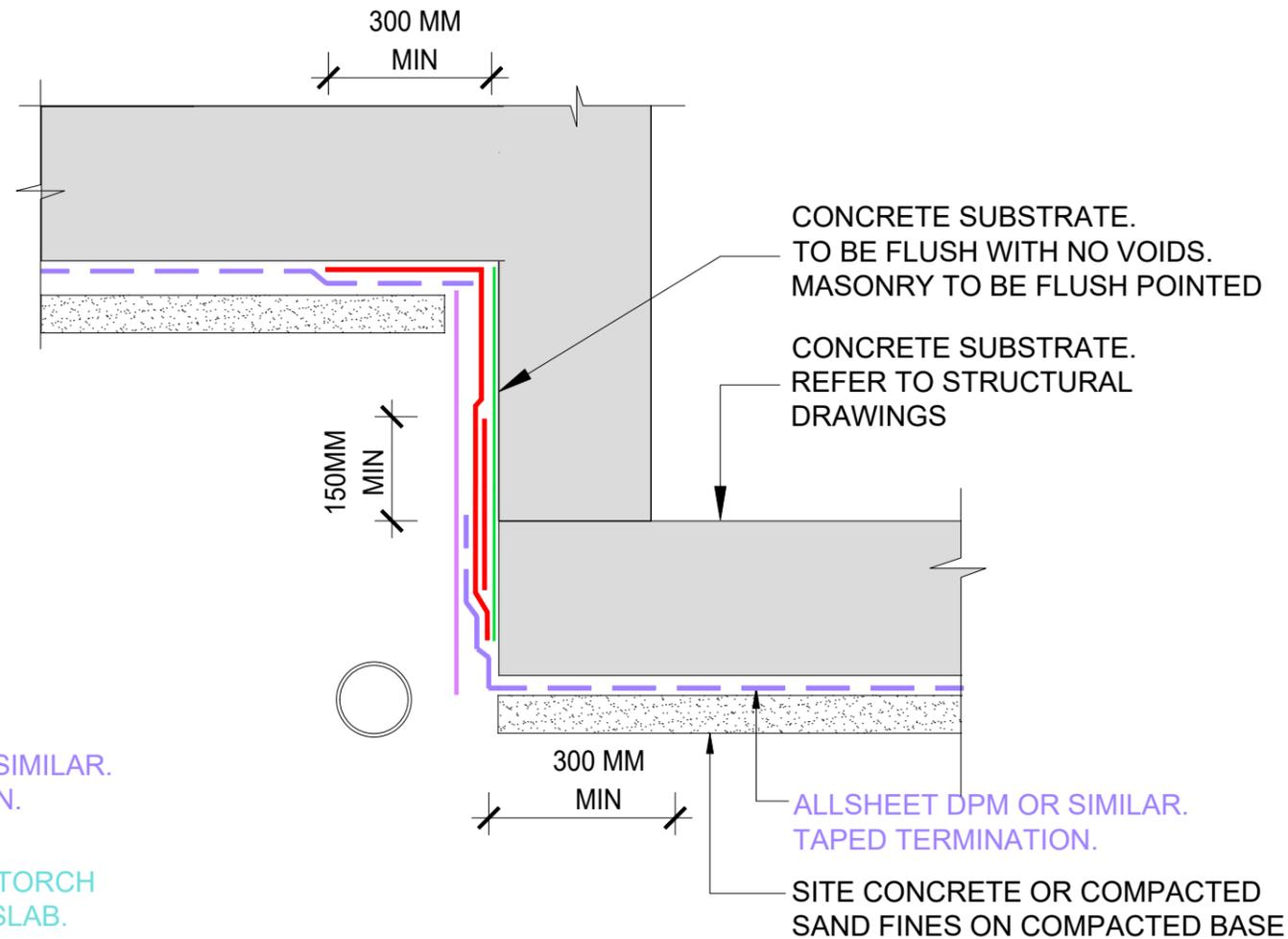
**2 RETAINING WALL / FLUSH FOOTING JUNCTION - MULTILEVEL**
