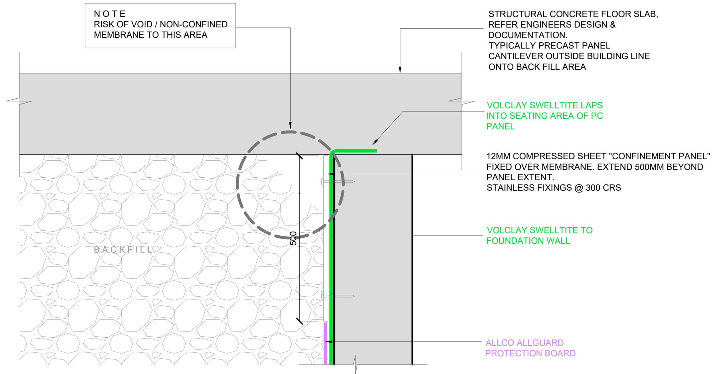
1 FLOOR SLAB / CANTILEVERED BALCONY ON GRADE / BACKFILL
