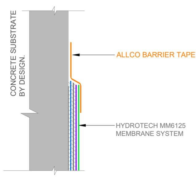
B ALLCO BARRIER TAPE TERMINATION 'TYPE B'
